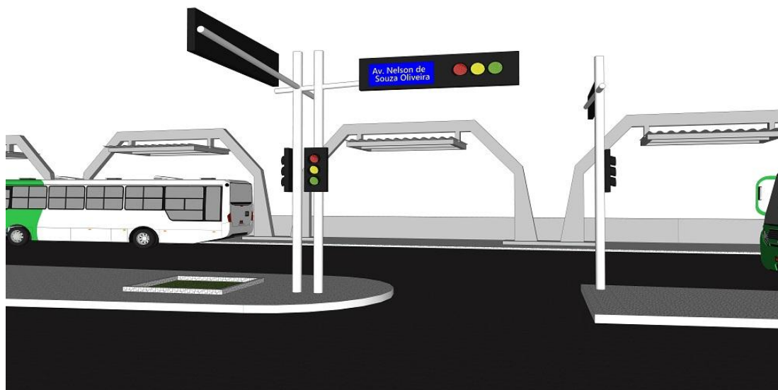
Figura 6 - Semáforos automatizados com contagem de veículos
